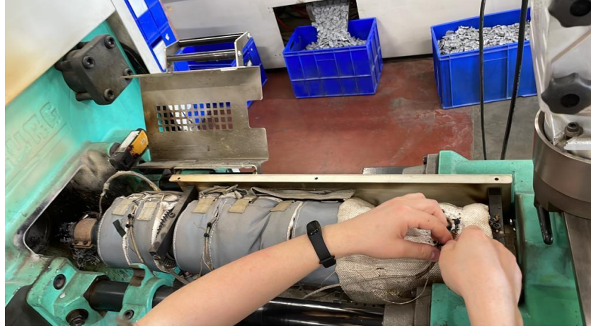
Şekil 2.2: Termokuplların makineye yerleştirilmesini gösteren resim
